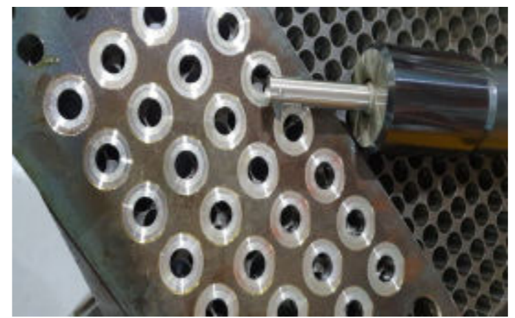
After back spot-faced test (hole \Phi 13.1 \rightarrow spot faced \Phi 26.2 ) 백 페이싱 테스트후의 사진 (홀 \Phi 13.1 , 페이싱 \Phi 26.2 )
