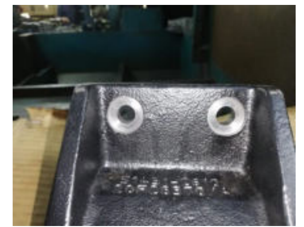
After back spot-faced test on forged steel (hole \Phi 13.1 \rightarrow spot faced \Phi 26.2 ) 단조강에 백 페이싱 작업후 사진 (홀 \Phi 13.1 , 페이싱 \Phi 26.2 )
